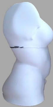
links: 3D-gedruckte Negativ-Hülle rechts: Füllung der Hülle mit Gips, Verbindung der Einzelteile und Erhalt des Positivs
