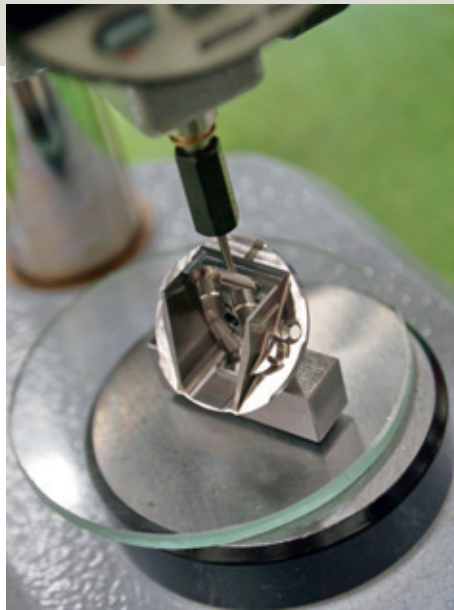
Die Einzelteile des Bone Anchored Ports werden vermessen. Kein einziger Kratzer darf auf der gefrästen Metalloberfläche vorhanden sein.
